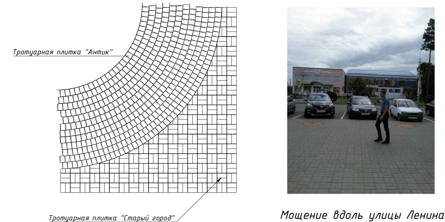
Схема мощения тротуарной плиткой
